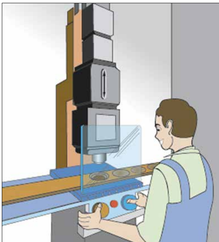
Слика 23а. Применете инженерски контроли, како што е контролата со две копчиња за опасна преса, така што работниците нема да бидат изложени на ризици што се својствени за работата
